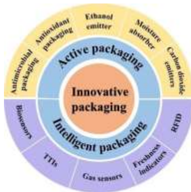
Joonis 4.2. Uuenduslike toiduainete pakendamise süsteemide klassifikatsioon. (TTI-d: aja-temperatuuri indikaatorid; RFID: raadiosagedustuvastus)
